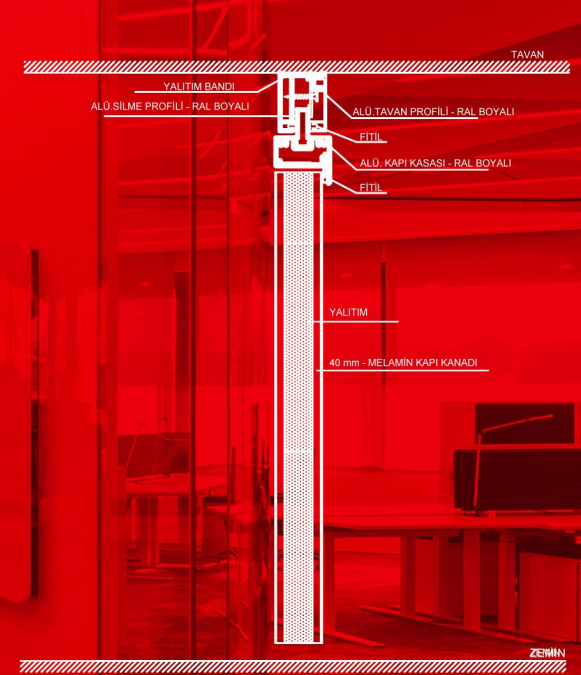
KLASSE MODÜLER BÖLME DUVAR (TEK CAMLI CAM CAMA BİRLEŞİMLİ)
